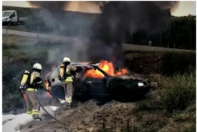
Löscheinsatz nach ca. 10 Sek. mit F-500
